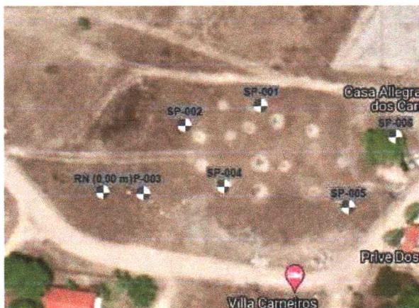
Os perfis de sondagem identificaram água a 3,5 metros de profundidade, e areia pouca a medianamente compacta até profundidade de aproximadamente 3,0 a 4,0 metros. Dependendo do tipo de empreendimento a ser construído no local, será preciso fazer remoção desta areia ou reforço no solo.
